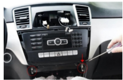
7、Entriegeln Sie die CD-Player-Verriegelung 8、Entfernen Sie den CD-Player und
