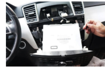
7、Entriegeln Sie die CD-Player-Verriegelung 8、Entfernen Sie den CD-Player und
