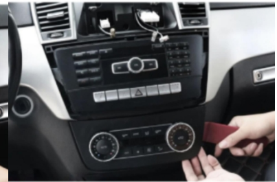
6、Demontieren Sie die Klimaanlage und entfernen Sie sie
