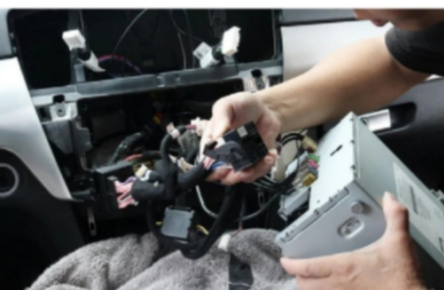
13、Anschließen und Einstecken von Kabeln Halterung
