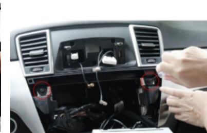
6、Demontieren Sie die Klimaanlage und entfernen Sie sie
