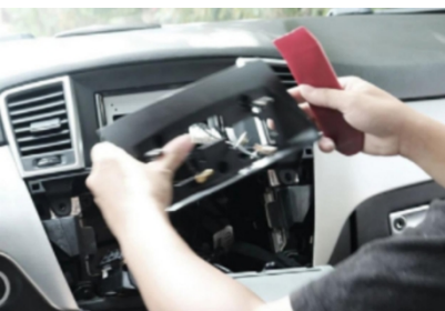
10、Entfernen Sie die Kunststoffhalterung Lüftungsdüse aufhebeln und entfernen
